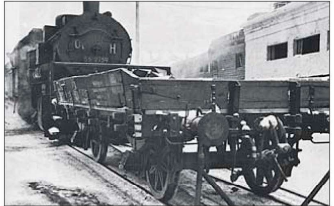
Слева: Перевозка тяжелых танков «Тигр» на шестиосных платформах типа SSyms. На танках узкие «транспортные» гусеницы. Справа: Советская двухосная платформа с перепрессованными на «европейский» рельсовый стандарт колесными парами и немецкий паровоз серии 55. В данном случае эта платформа играет роль защиты немецкого поезда от рельсовых мин. Снимок сделан на станции Орша в 1942 году.
